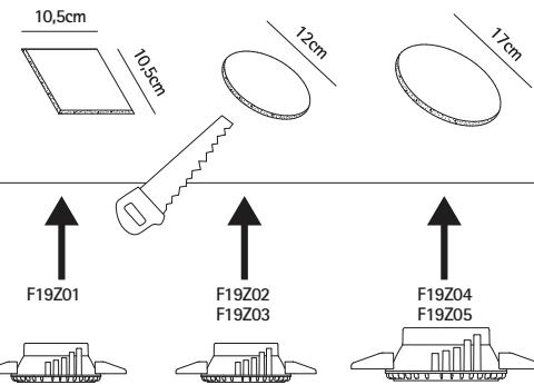
Scegliere la dimensione del foro da fare sul cartongesso in base al tipo di cassaforma.
