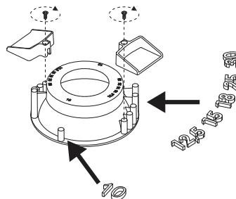
La cassaforma viene fornita già predisposta per lo spessore di 12,5 mm del cartongesso. Per spessori diversi spostare le alette.
